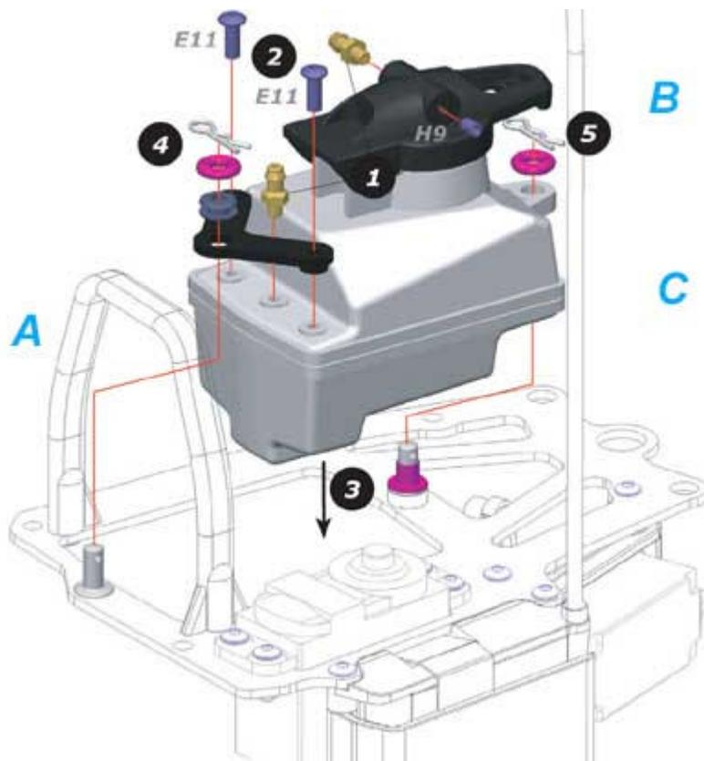
WICHTIG! Prüfen Sie, dass die Treibstoffleitung und die Druckleitung frei von Schmutz und nicht blockiert ist.
