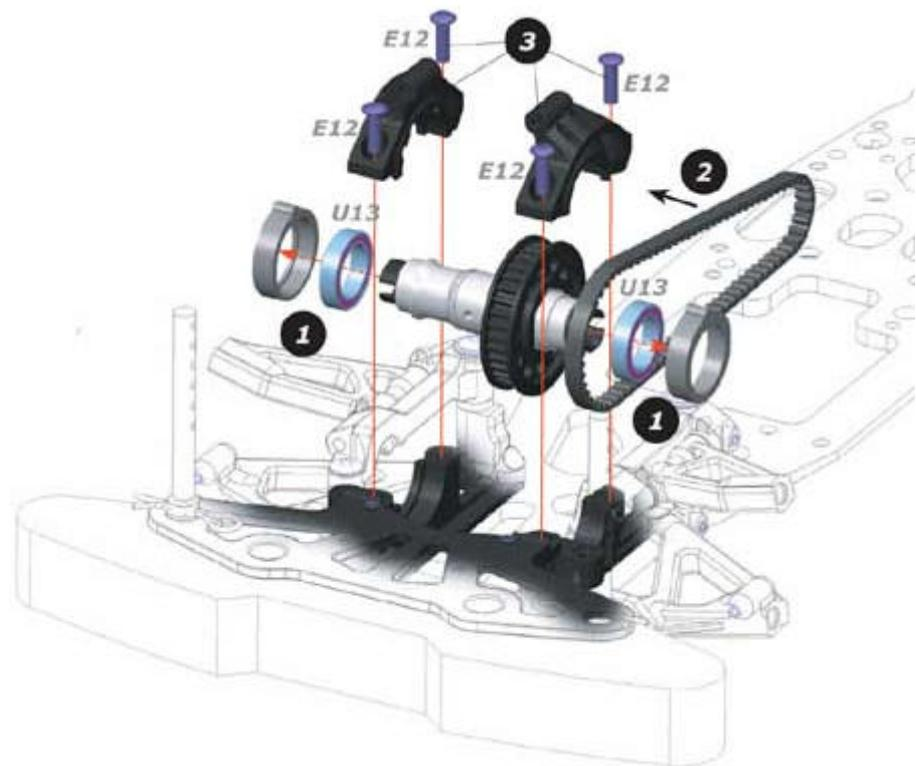
A) Verändern sie die Position **BEIDER** Exzenter, um die Spannung des vorderen Riemens einzustellen. Beide Exzenter sollten sich in der gleichen Position befinden
