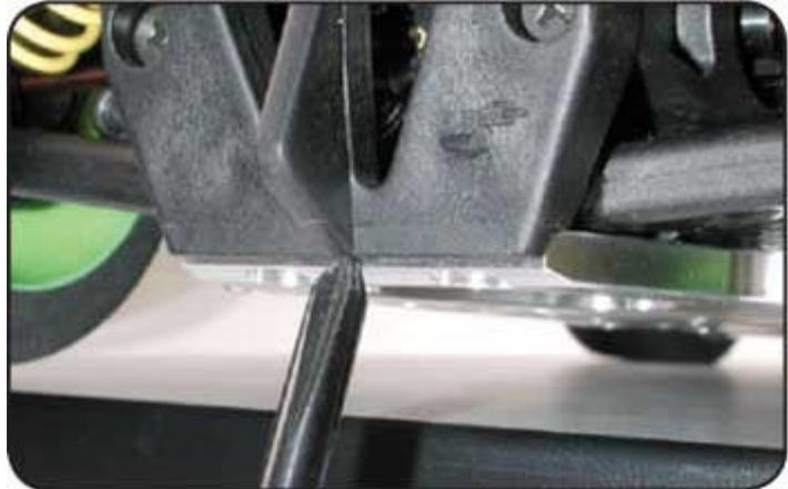
Stellen Sie die Federvorspannung der vorderen Federn so ein, das beide Hinterräder gleichzeitig von der Einstellfläche abheben. Wenn z.B. das hintere rechte Rad zuerst anhebt, müssen Sie die Vorspannung der vorderen linken Feder erhöhen und die Vorspannung der vorderen rechten Feder reduzieren. Sie müssen die Vorspannung beider Federn verändern, da sich andernfalls die Bodenfreiheit verändern wird.
