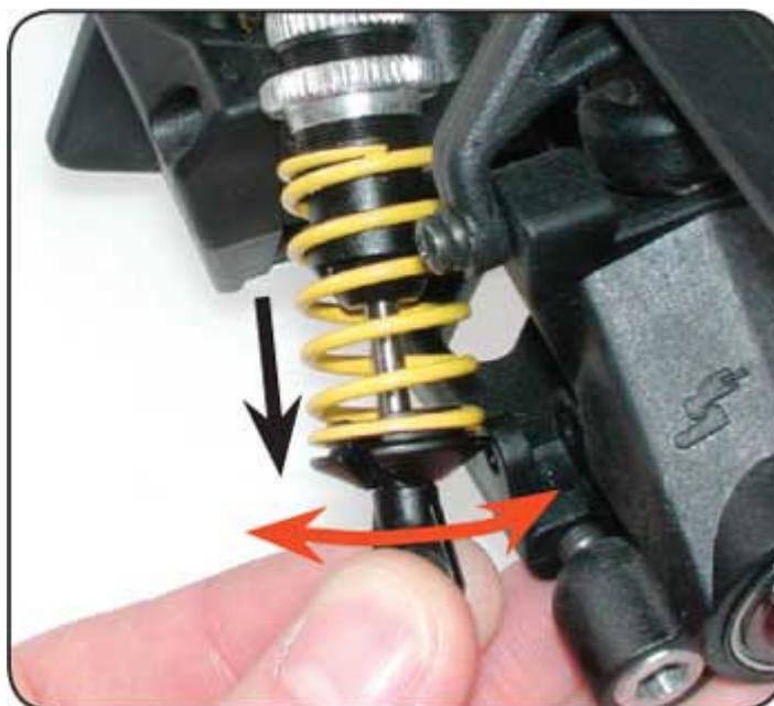
Dämpfer zerlegen zu müssen. Ziehen Sie die Kolbenstange heraus und drehen Sie diese vorsichtig, bis der Kolben im Dämpferzylinder einrastet. Ein kpl. Verdrehen der Kolbenstange im Uhrzeigersinn öffnet 2 Löcher (härteste Einstellung). Ein Verdrehen gegen den Uhrzeigersinn aus dieser Position heraus öffnet weitere Löcher und ergibt eine weichere Einstellung. Es sind 4 Positionen möglich (2-3-4-5 Löcher), wovon jede durch einen weichen "Klick" spürbar ist, wenn Sie die Kolbenstange verdrehen.
