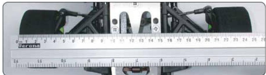
hintere Spurbreite ebenfalls symmetrisch eingestellt wird, was bedeutet, dass das rechte und linke Rad jeweils gleich weit von der Mitte des Chassis entfernt sind.
