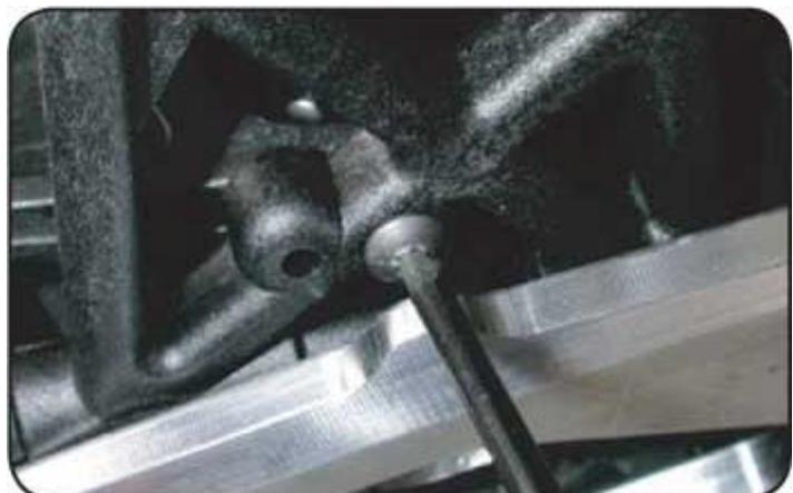
reduzieren. Stellen sie bei der Einstellung des Ausfederwegs sicher, dass Sie auf der linken und rechten Seite eine jeweils gleiche Einstellung vornehmen.
