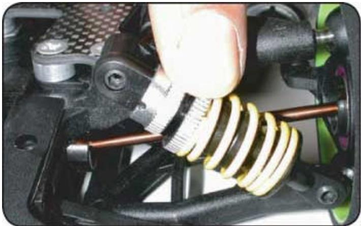
Hängen Sie den vorderen Stabilisator wieder ein und prüfen Sie dann das Fahrwerk erneut auf Asymmetrie, indem Sie das Fahrzeug hinten anheben. Wenn ein Rad vor dem anderen von der Einstellfläche abhebt, ist die Vorderachse des Fahrzeugs asymmetrisch eingestellt. Lösen Sie die Schraube an der rechten vorderen Stabilisatorbefestigung. Stellen Sie den Exzenter so ein, dass beide Hinterräder gleichzeitig vom Boden abheben. Ziehen Sie die Schraube anschließend wieder fest, um den Exzenter zu sichern.
