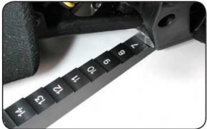
Hinweis: Sofern Sie zur Messung des Ausfederwegs die Stoßdämpfer demontiert haben, montieren sie diese wieder; Montieren Sie NICHT die Stabilisatoren.
