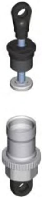
Con el amortiguador lleno de aceite enrosca lentamente el tapón inferior en el cuerpo del amortiguador.
