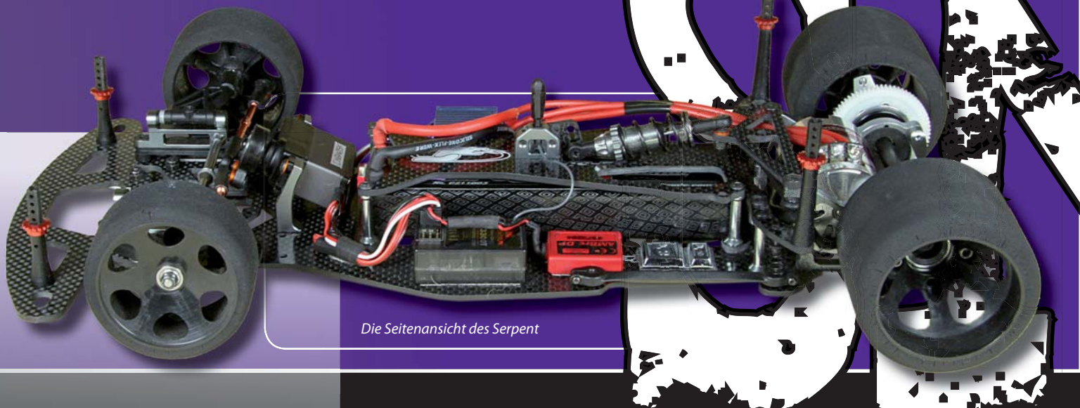
Dieser Dämpfer nimmt die Rollbewegungen des Chassis auf
