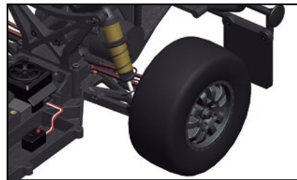
Radachsen und Antriebswellen
